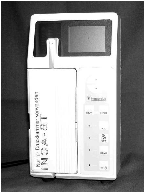
Abb. 1: Druckkammer-tauglich modifizierte Infusionspumpe. Größe der Pumpe: B14 x H26 x T6 cm (Inca ST, Fa. Fresenius)
