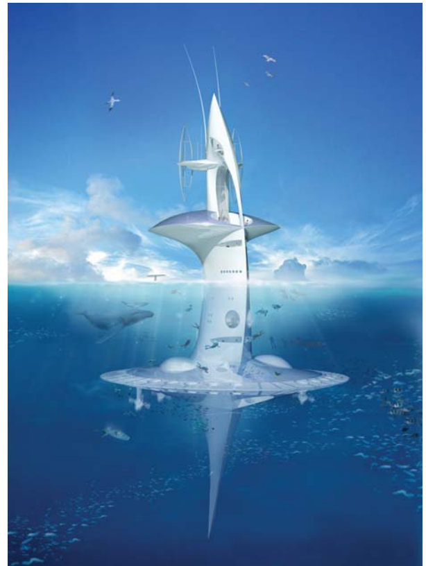
Abb. 1: Der SeaOrbiter kann gleichzeitig Messungen über und unter dem Meeresspiegel durchführen und zusammenbringen. Schlauchboote oder Mini-U-Boote gestatten Exkursionen in die nähere Umgebung. Ferngesteuerte Kameras liefern zusätzlich Aufnahmen aus Tiefen bis zu 600 m.
