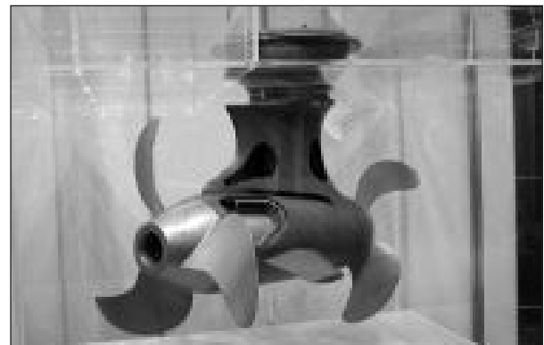
Abb. 3: Bei der MERIAN ist der eigentliche Fahrmotor in einer Art Gondel (englisch: pod) direkt unter dem Heck angebracht. Im Schiff befinden sich die Dieselaggregate und die Generatoren, die den Strom erzeugen. Damit sind wenig Schallquellen (z.B. keine Getriebe) im Schiff vorhanden. Der elektrische Antrieb ist insgesamt ruhig und sehr sparsam. Der Pod-Antrieb ermöglicht ein hervorragendes Manövrieren in alle Richtungen und eine sehr langsame Fahrt über sehr lange Zeiträume
