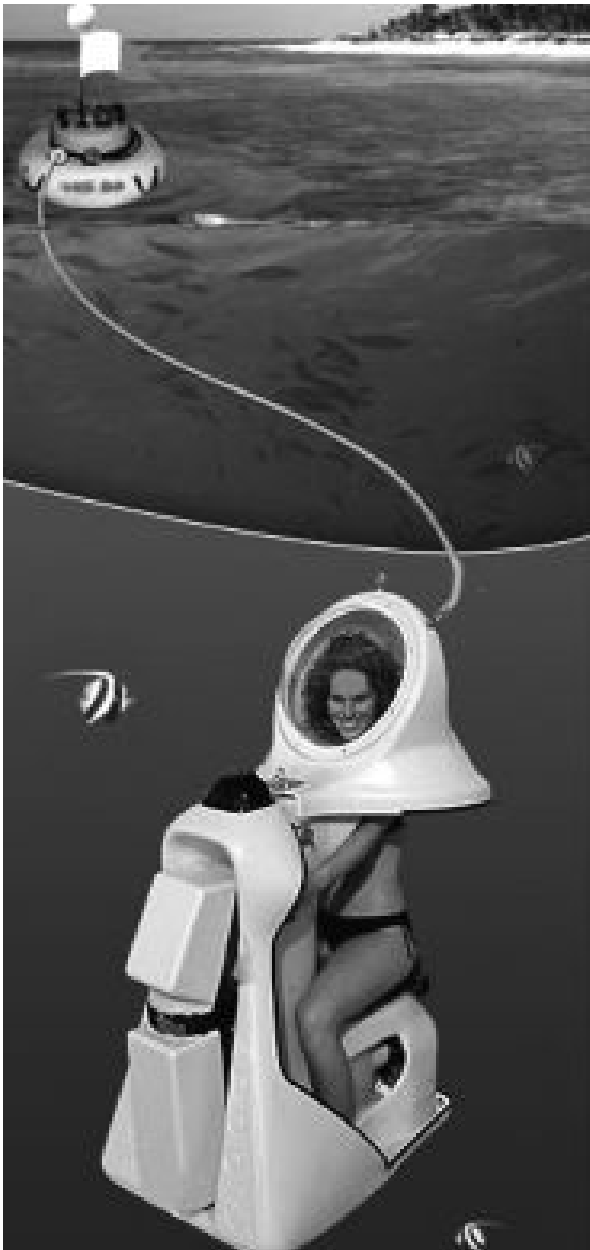
Abb. 1: Das Scubadoo bewegt sich auf einer Tiefe von maximal 3 m. Die aufrechte Position des Systems wird durch die tief liegenden Batterien und den Elektromotor, die luftgefüllte Halbkugel und die an der Oberfläche mitgezogene Boje gewährleistet. Der Benutzer sitzt in dem System wie auf einem Motorrad. Er kann das Gerät steuern. Ein 'Tauchgang' soll etwa 20 min dauern. In dieser Zeit wird kontinuierlich Frischluft aus einem Druckluft-Tauchgerät mit einem Fluss von 25 l/min abgegeben
